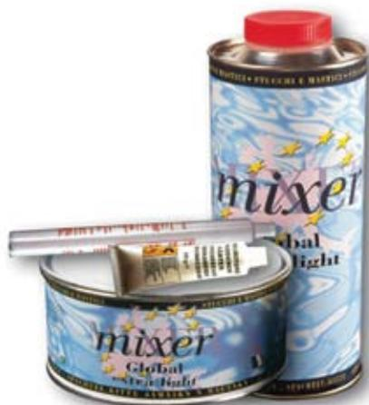
Stucco a base poliestere multifunzionale con le stesse caratteristiche dello stucco GLOBAL, ma con una texture molto più leggera che lo rende uno stucco ideale per lavori di rifinitura e riempimenti di piccoli fori ed imperfezioni. Perfetta aderenza su lamiere zincate, elettrozincate e in alluminio che non pregiudica le proprietà intrinseche del prodotto. Facile da applicare, essiccazione rapida e carteggiabilità finale veloce e facile.
